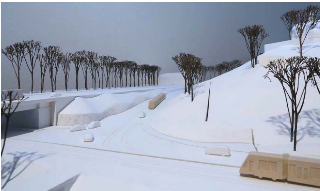
Abbildung 3: Modellfoto: Blick auf den Margarethenstich mit der neuen Stützkonstruktion auf der Seite Dorenbachviadukt und der neuen Strassenraumaufteilung.
