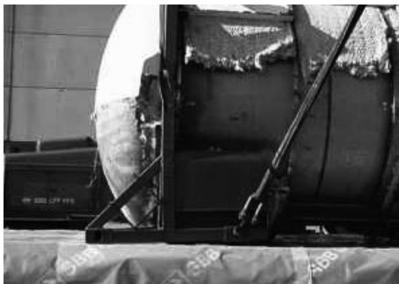
Der von der Isolation freigelegte Tankcontainer.
