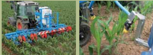
Abb. 2 : Gekoppeltes System zum Spritzen in den Reihen und Hacken zwischen den Reihen
