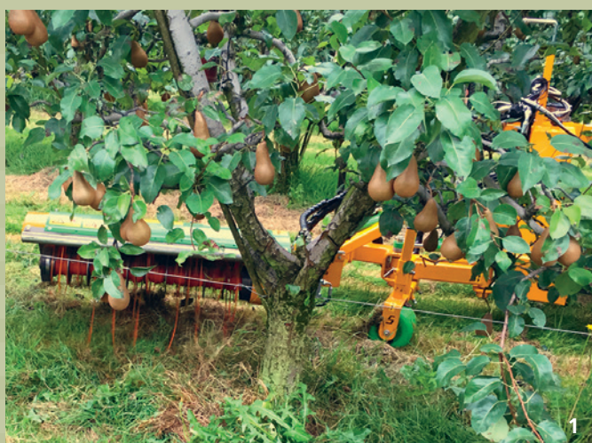
Mittels Fadengerät kann der Herbizideinsatz reduziert werden.
