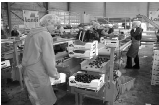
Innovation wird grossgeschrieben: Tafelkirschen-Kalibrieranlage der Frunoba AG
