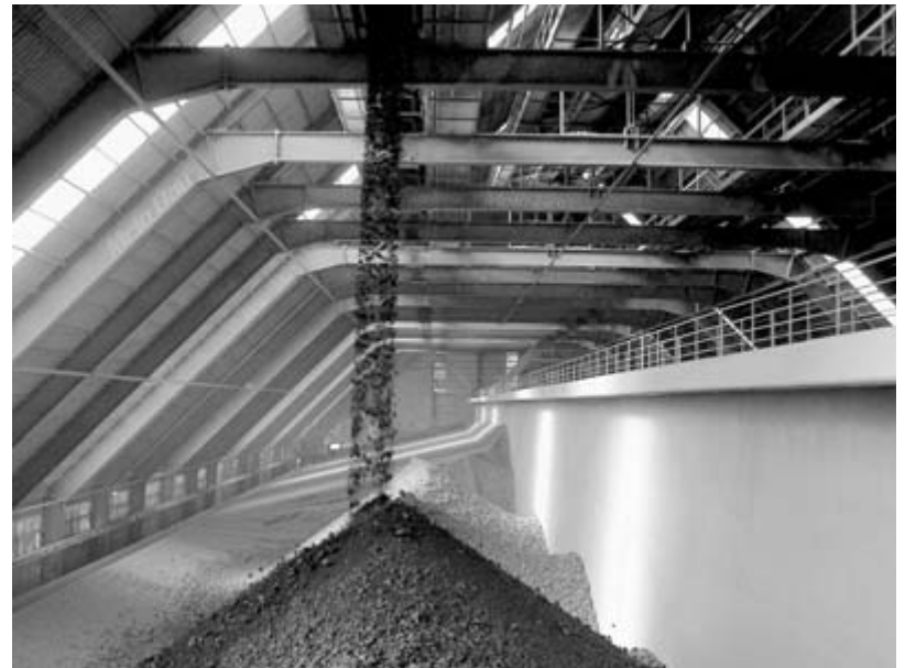
Das A.RO.MA. gelangt in die Rohmaterialhalle, wo es in kontrollierten Mengen der Zementproduktion zugeführt wird.
