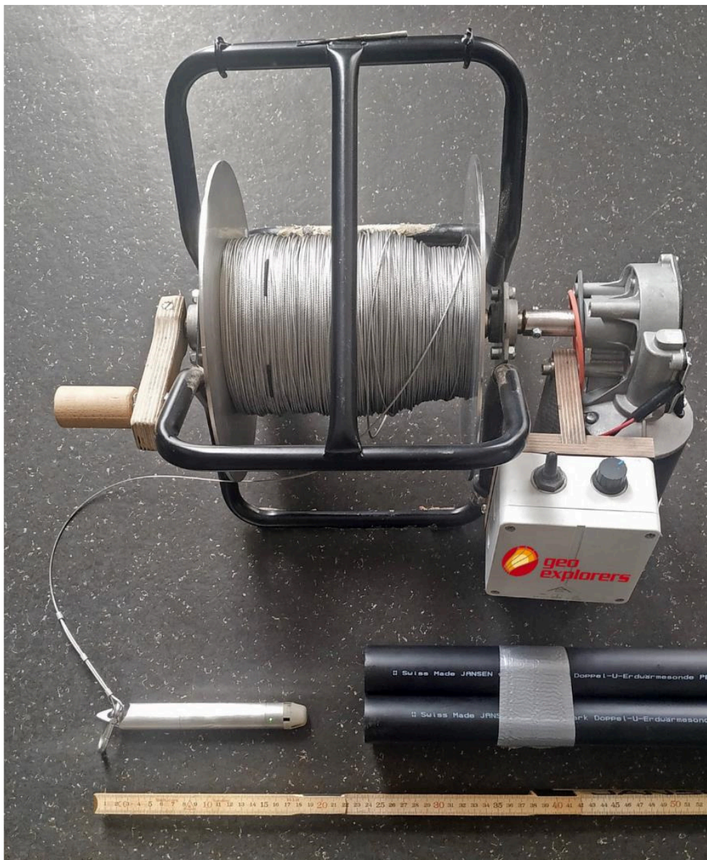
Abb. 2: Geofish mit Sondenrohr (PN16, \varnothing 40 mm) zum Vergleich
