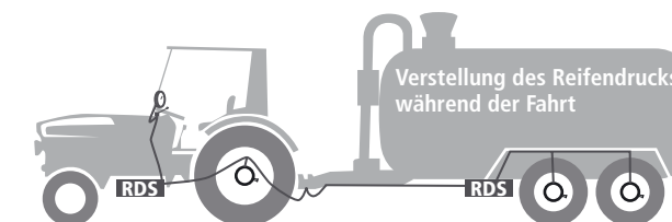
Abb. 8 Regeldrucksysteme schaffen Abhilfe! Kompromiss zwischen Feld- und Strassenfahrten.
