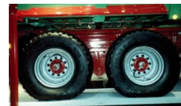
Abb. 9 Anhänger mit reduziertem Pneuinndruck für Feldeinsatz.
