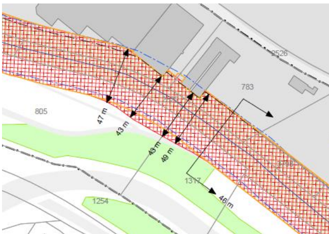
Darstellungsbeispiel für punktuelle Vermessungen (links) und für die Vermassung eines gleich breit bleibenden Korridors (rechts)
