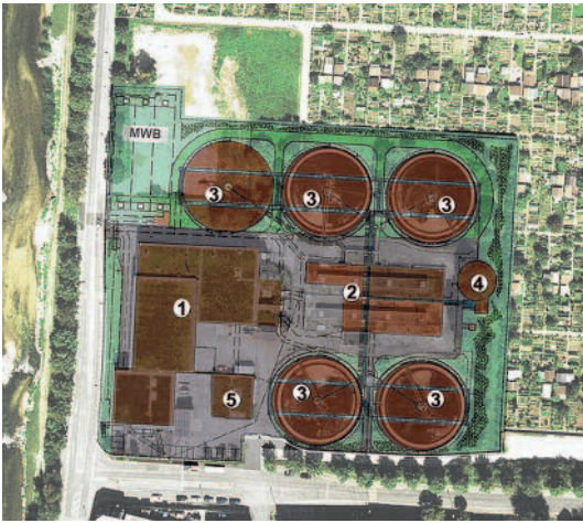
Abb. 2 Integration der neuen ARA Birnsee in die bestehende Infrastruktur. 1: Mechanische Vorreinigung, 2: Zentrales 2-geschossiges Schlammbehandlungsgebäude mit integriertem Vorlagebehälter im UG, 3: SBR-Reaktoren, 4: Faulturm, 5: Betriebsgebäude.
